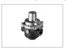
Клапан редукционный тип 11BIS является регуляторами давления прямого действия «после себя» и предназначен для снижения и поддержания постоянного давления за клапаном вне зависимости от колебаний давления до него.
