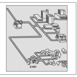
Регулирующий клапан C101 уменьшает и поддерживает постоянное пониженное давление «после себя» независимо от изменения давления до регулятора и водоразбора после него.
