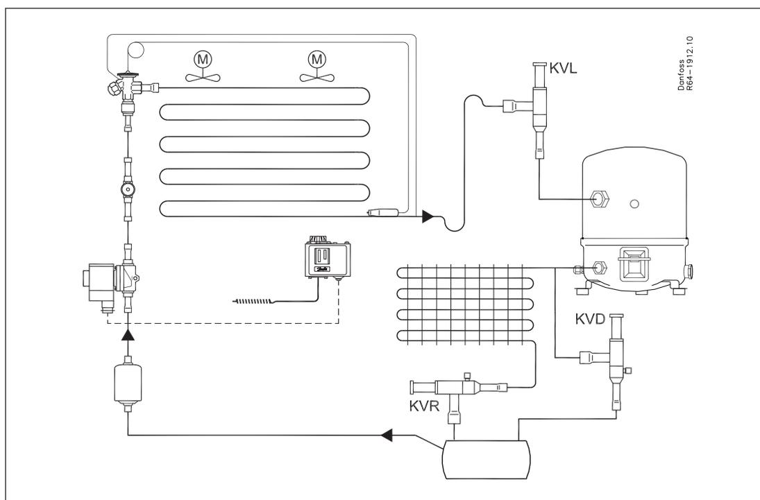
Повышение давления всасываемого газа приводит к росту потребляемой компрессором мощности и величины рабочего тока, а так же может привести к перегреву и отключению компрессора. Установка регулятора давления в картере KVL защищает компрессор от чрезмерно высокого давления газа во всасываемой магистрали, что позволяет избежать:
