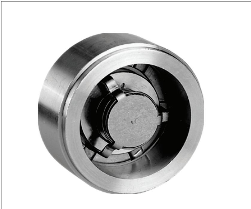
Обратные клапаны типа NRVS не обладают демпфирующими свойствами и поэтому могут использоваться только в линиях жидкости. Эти клапаны устанавливаются непосредственно на клапаны РМ или соленоид-ные клапаны EVRA/EVRAT.
