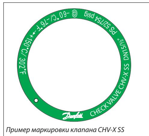
Пример маркировки клапана CHV-X SS
