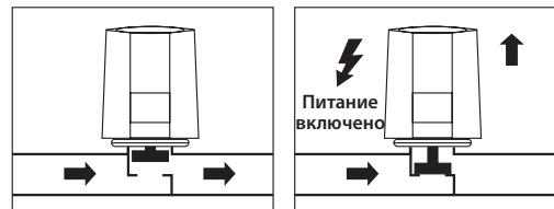
Функциональный индикатор для версий НО выдвигается приблизительно на 0,5 мм только при полном закрытии клапана.
