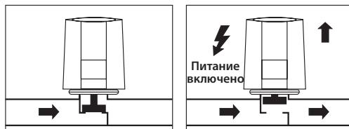
Функциональный индикатор для версий НЗ выдвигается на высоту от 0 мм до 5–6 мм при открытии привода.
