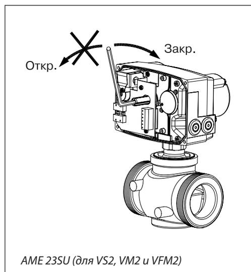
Ручное позиционирование выполняется при снятой крышке привода и отключенном питающем напряжении. Для позиционирования используется 6-мм (для АМЕ 13SU) или 5-мм (для АМЕ 23SU) торцевой шестигранный ключ (в комплект поставки не входит). Ключ вставляется в отверстие шпинделя привода и поворачивается в сторону противодействия пружины. При позиционировании следите за индикатором поворота. Чтобы закрепить положение шпинделя, необходимо зафиксировать ключ.
