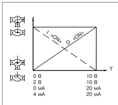
В выключенном положении электропривод работает в диапазоне 0(2)–5(6) В или 0(4)–10(12) мА, в положении «ON» — 5(6)–10 В или 10(12)–20 мА.
