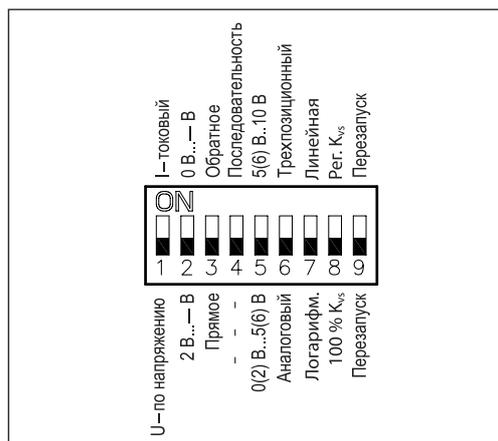
Электропривод оснащен блоком микропереключателей выбора функций DIP, который находится под съемной крышкой. В частности, если переключатель (6) поставлен в позицию «ON», электропривод начинает работать как трехпозиционный.
