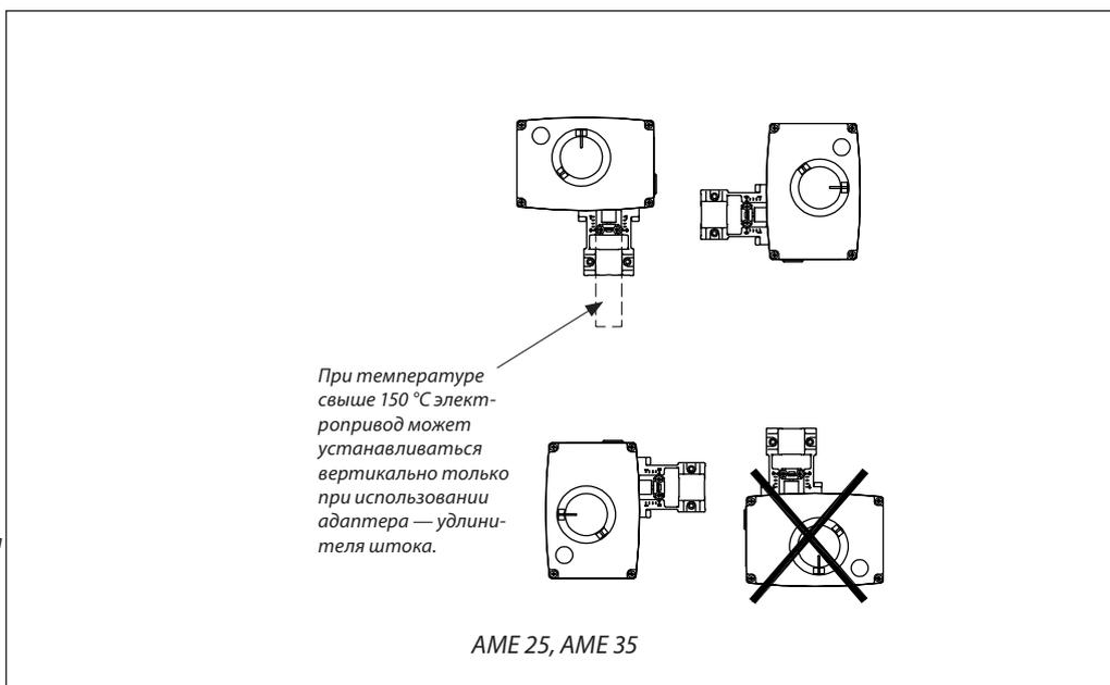
Примечание. При температуре теплоносителя свыше 150 °С электропривод без адаптера — удлинителя штока должен устанавливаться на клапан только горизонтально.
