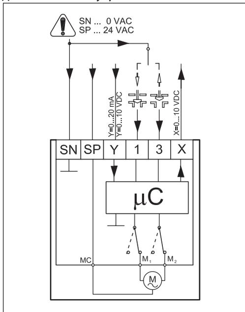
**Автоматическая подстройка хода штока привода к ходу штока клапана**
