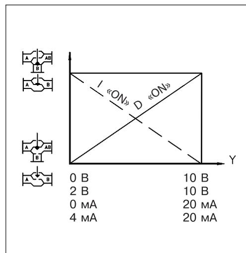
В выключенном положении электропривод работает в диапазоне 0(2)–5(6) В или 0(4)–10 (12) мА, в положении «ON» — 5 (6)–10 В или 10 (12)–20 мА.
