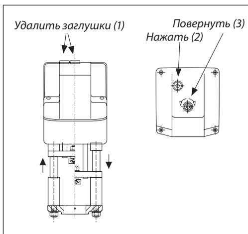
Ручное позиционирование производится 8-мм торцевым шестигранным ключом (не входит в комплект поставки), поворотом его до требуемого положения.
