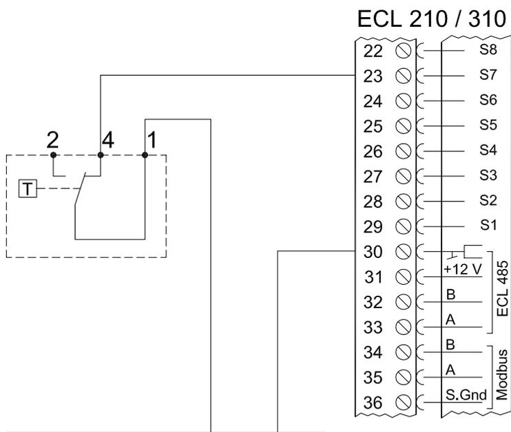
**Подключение датчика пожарной безопасности S8**
