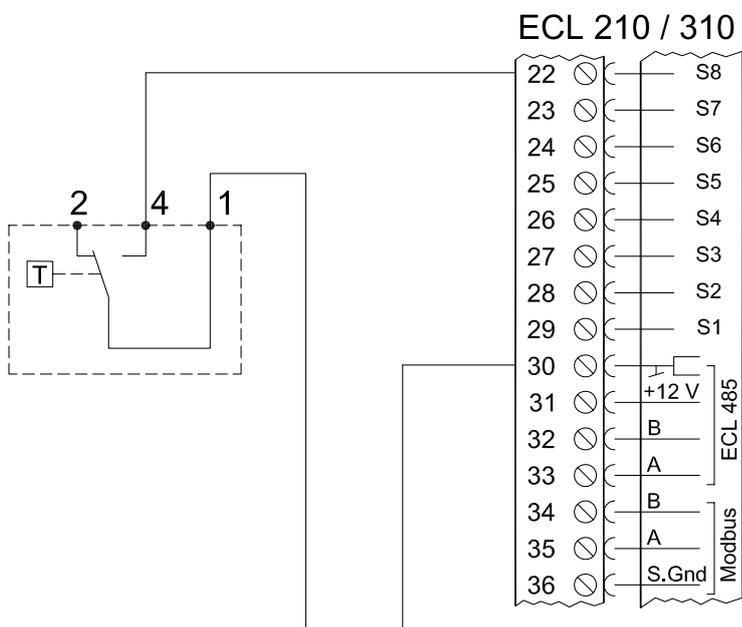
При срабатывании датчика пожара контакты 1–2 размыкаются.
