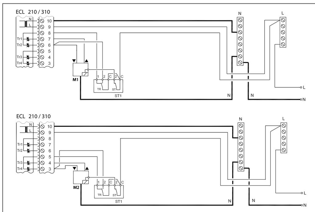
Неправильное подключение внешнего оборудования и питания может привести к повреждению регулятора. Сечение проводов силовых цепей — 0,5–1,5 мм<sup>2</sup>. К каждой винтовой клемме может присоединяться максимально два провода сечением до 1,5 мм<sup>2</sup>.
