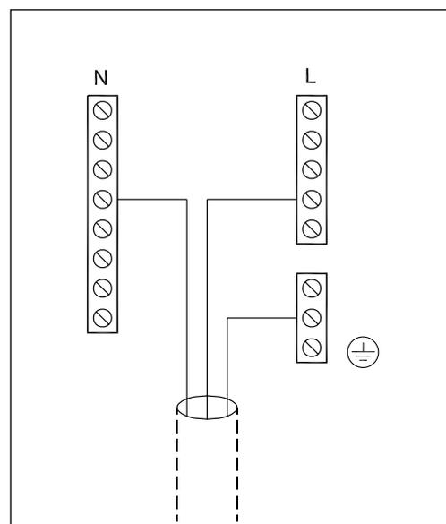
**Электрические соединения регулятора на ~ 230 В (для приложения A217.1)**
