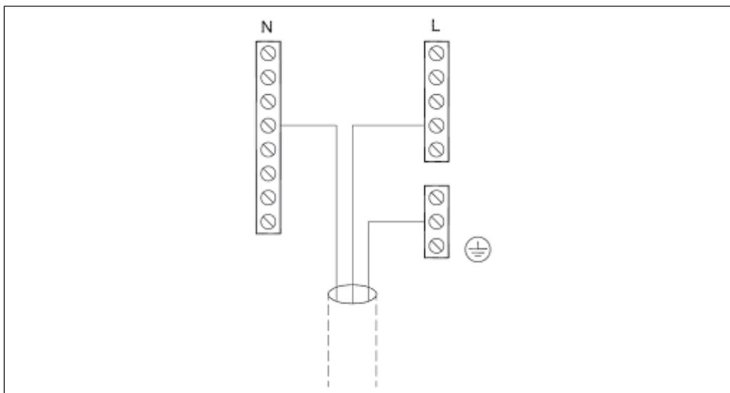
Общая клемма заземления используется для подключения соответствующих компонентов (горелок, насосов, клапанов с электроприводами).
