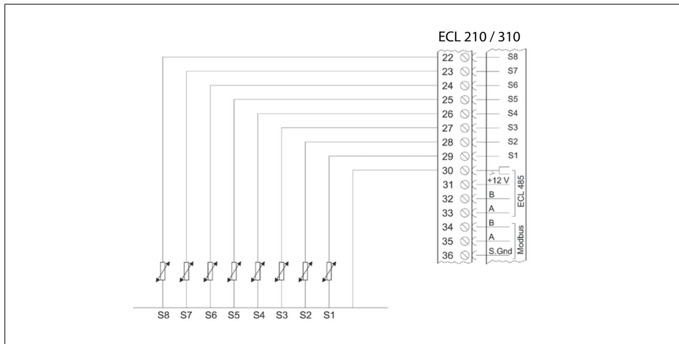
Электрические соединения дистанционного задатчика требуемой температуры котла (сигнал 0–10 В)
