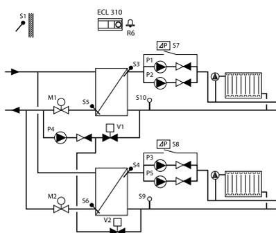
Приложение A361.2. Две системы отопления, присоединенные к тепловым сетям централизованного теплоснабжения по независимой схеме (с возможностью ограничения температуры возвращаемого теплоносителя в соответствии с температурой теплоносителя на входе в тепловой пункт). Управление спаренными циркуляционными насосами и системой подпитки
