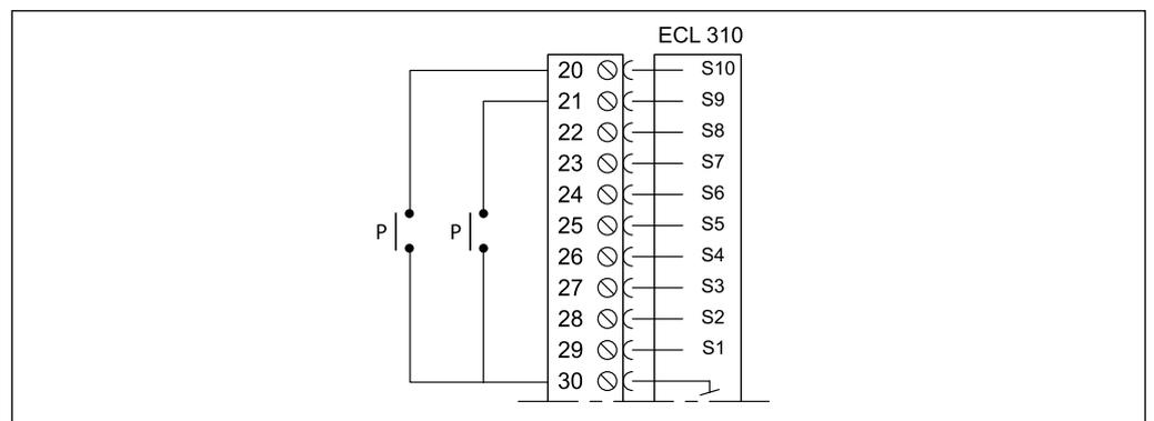
**Электрическое соединение ECA 30/31 с ECL Comfort 310**
