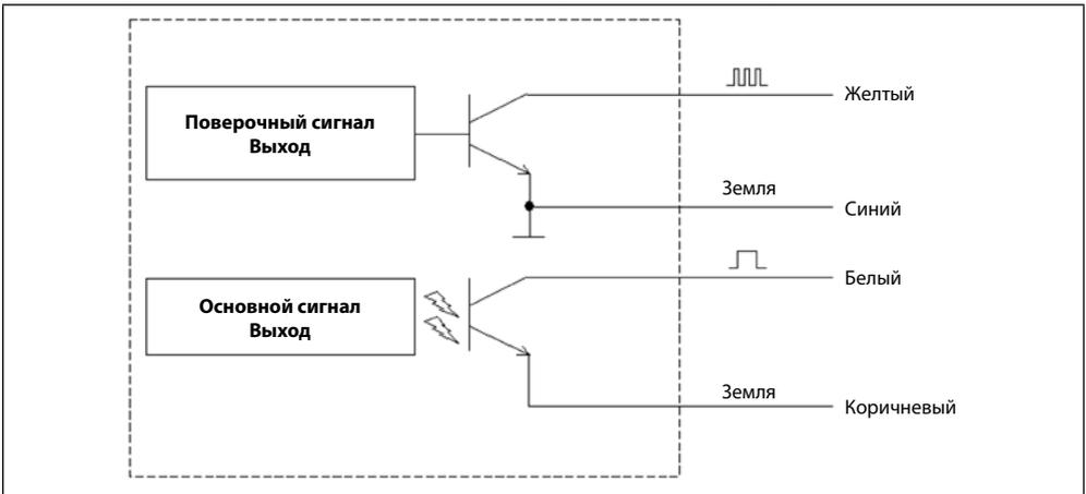
2. Схема соединения расходомера типа SONO 1500 CT с вычислителем СПТ 943.1:
