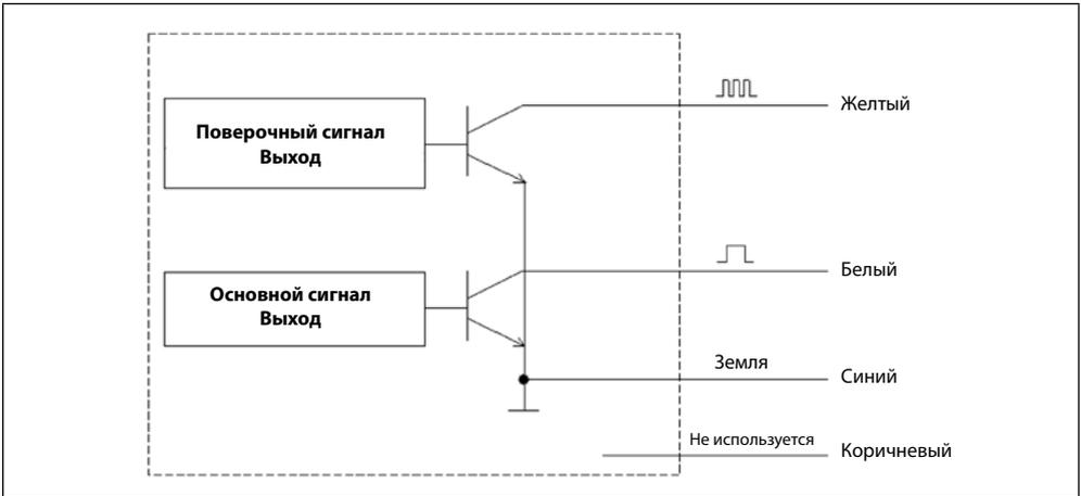
Расходомер типа SONO 1500 CT с гальванически-развязанным импульсным выходом:
