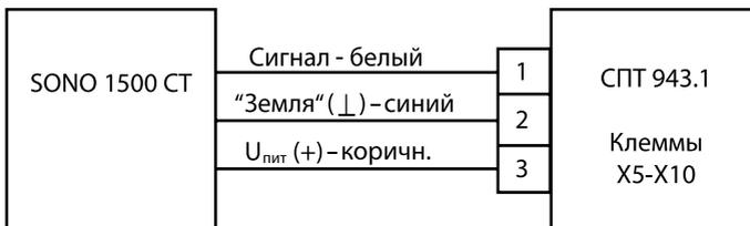
3. При наращивании многопроволочного кабеля импульсного выхода расходомера должны использоваться клеммные коробки с зажимами, либо провода могут соединяться методом пайки или опрессовки. Соединение должно быть выполнено в соответствии со СНиП 3.05.07-85.
