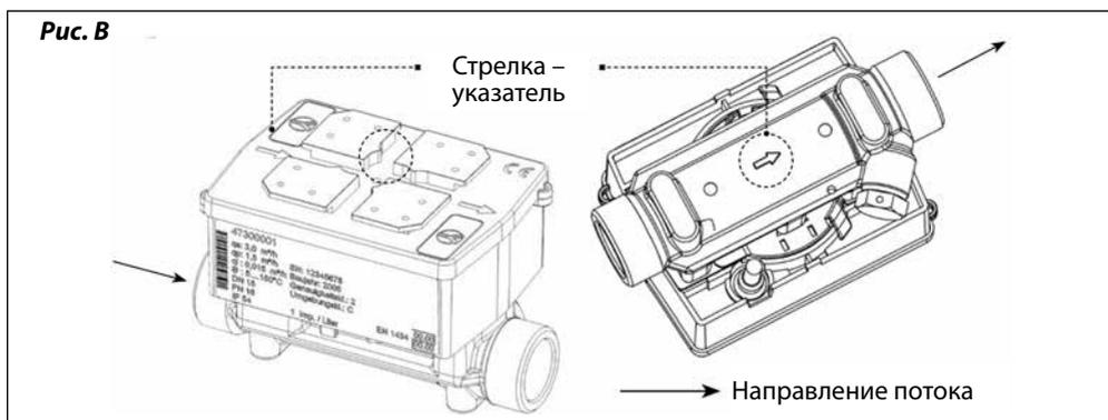
6. Расходомер может быть установлен как на вертикальном, так и на горизонтальном участке трубопровода. Однако, установка недопустима на участках, где могут собираться пузырьки воздуха (рисунок С).
